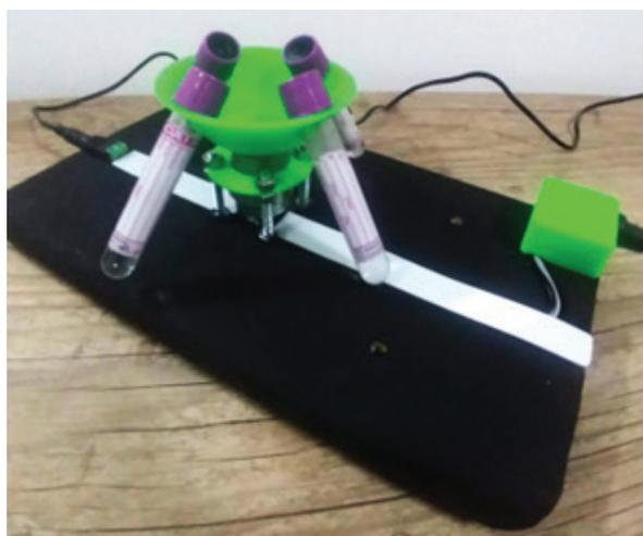
**Figura 1: Centrífuga 12v - Registro fotográfico da centrífuga de laboratório desenvolvida neste trabalho**
