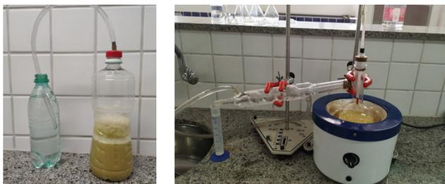
**Figura 3** – À esquerda, processo de fermentação em caldo de cana. À direita, aparato de destilação do mosto fermentado.
