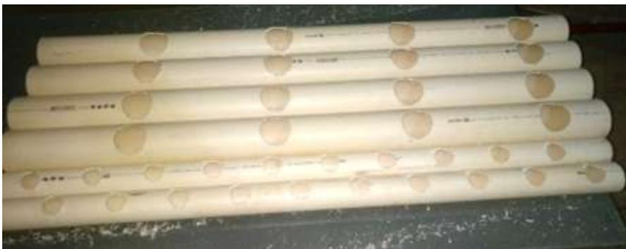
**Figura 67.** Canais de cultivo final e de mudas com a furação final. Fonte: Própria (2018).
