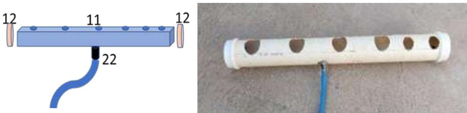
**Figura 70.** Esquema de montagem do coletor final de solução nutritiva da hidroponia caseira (esquerda); coletor pronto (direita). Fonte: Própria (2018).
