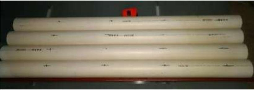
**Figura 65.** Tubos de esgoto  $\varnothing = 75$  mm para servir de canais de cultivo, com as devidas marcas a cada 25 cm. Fonte: Própria (2018).
