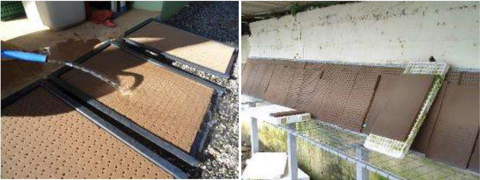
**Figura 44.** Lavagem da espuma fenólica. Fonte: Própria (2003).
