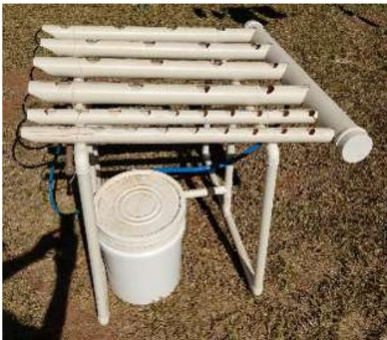
**Figura 64.** Bancada hidropônica caseira depois de pronta. Fonte: Própria (2018)
