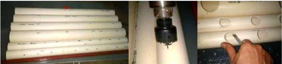
**Figura 66.** Tubos de esgoto  $\varnothing = 75$  mm para servir de canal de berçário para as mudas marcados a cada 10 cm (esquerda), detalhe da furação com serra copo (centro), retirada das rebarbas de PVC (direita). Fonte: Própria (2018).
