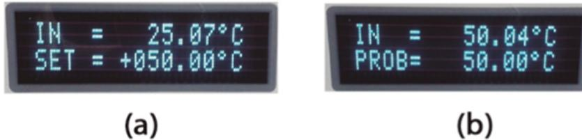
d) Anotar a temperatura apresentada pelo Pt-100 (IN) e pelo Probe (OUT) e o erro relativo entre eles;
