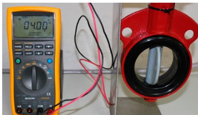
Figura 14.8 – Sinal de 20 mA aplicado no posicionador da válvula.
