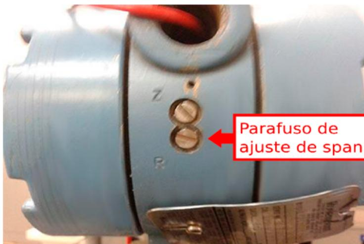
Figura 9.8 – indicação do ajuste de *span*.
