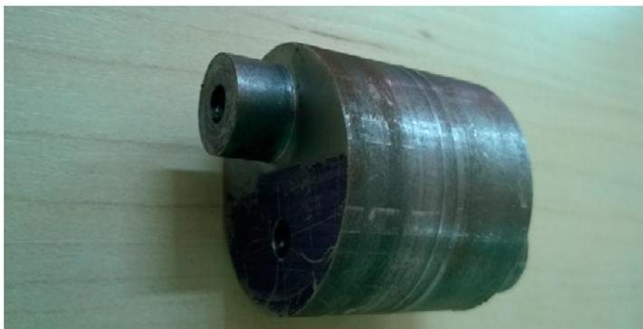
Na **Figura 2**, pode ser observado que as espigas têm diâmetros diferentes, conforme o que é especificado na ordem técnica de execução.
