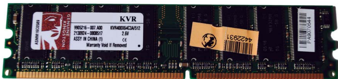
Figura 3.4 – Fotografia de uma memória RAM.
