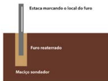
Furo de sondagem encerrado
