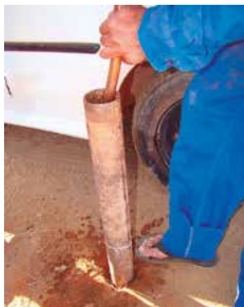
Introdução de água no furo de sondagem
