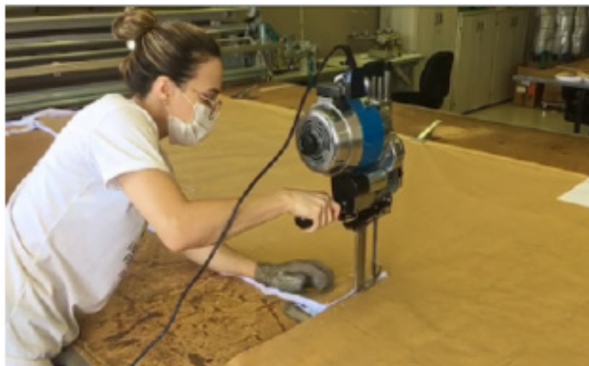
Figura 3 - Etapa de encaixe, enfiado do tecido e corte das máscaras reutilizáveis.
