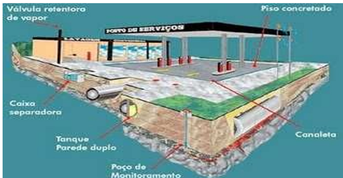
Figura 1: Estrutura de um Posto de Combustível
