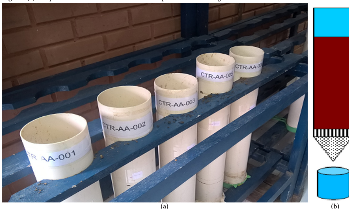
Figura 1(b) - Esquema da coluna de PVC na bancada do permeâmetro de carga constante
